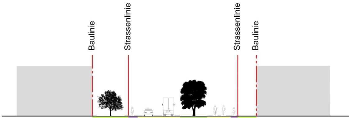
Abb. 4: Querschnitt Strassensituation mit Bau- und Strassenlinien
